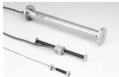
Czujniki zatapiane w konstrukcji podczas jej betonowania
